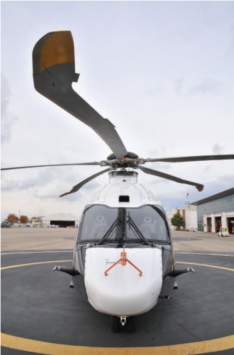
Les pales du H160 proviennent du concept Blue Edge d'Airbus Helicopters. Elles augmentent la charge utile de 100 kg.
