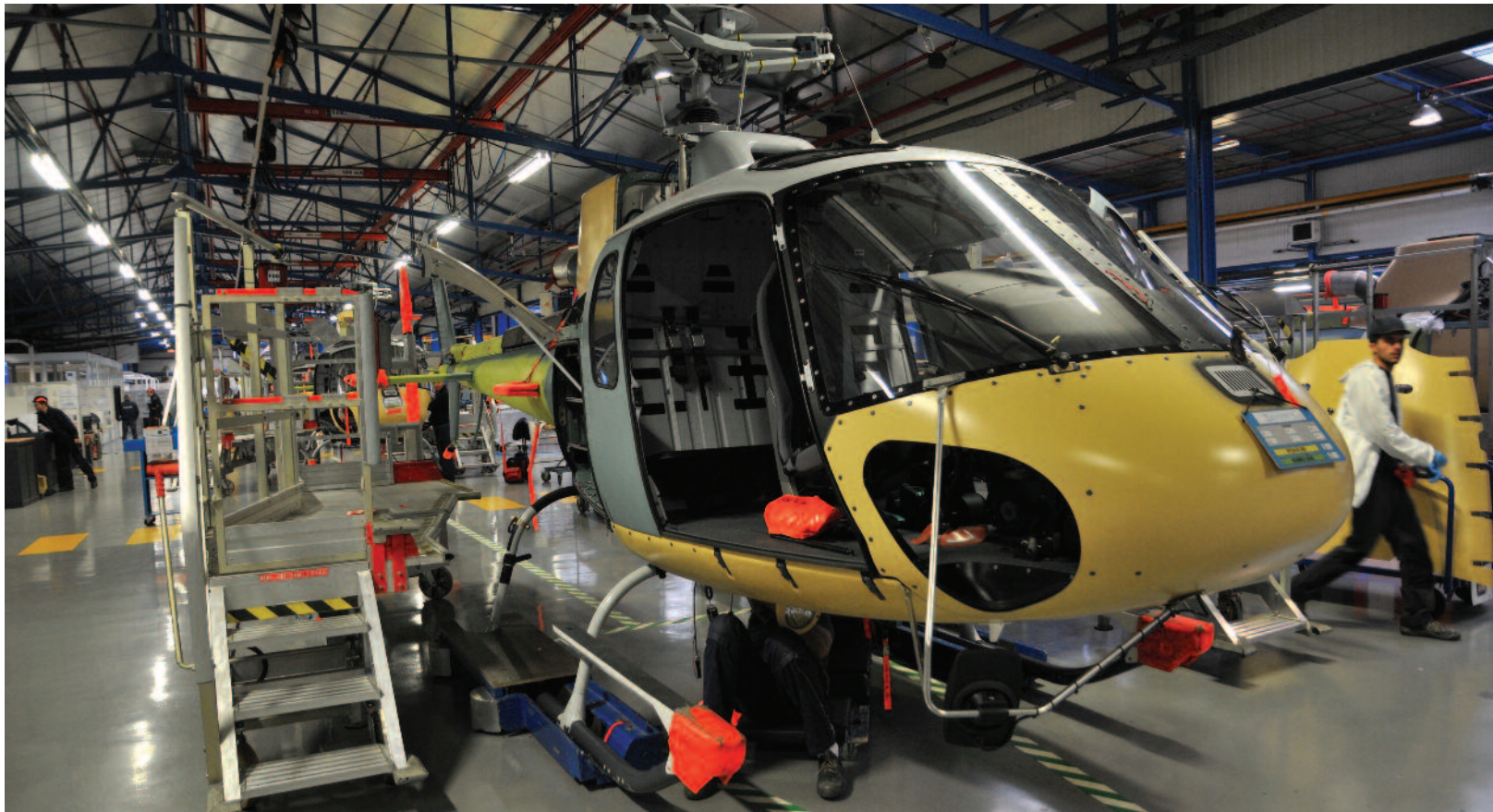
La chaîne d'assemblage finale des H125 et H130. Les deux types présentent des motorisations et des parties mécaniques communes.
