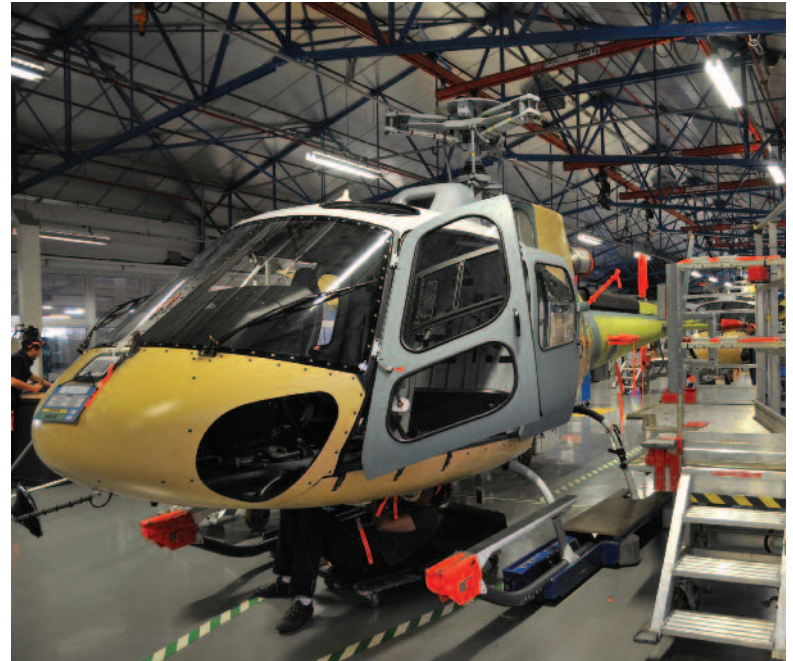
Un H125 en bout de chaîne d'assemblage.
